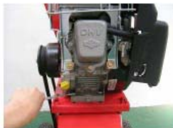
Povoľte 4 skrutky prichytávajúce motor k telu drviča.
