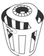
**Chránič nainštalujte medzi príruba objímke napájacieho kábla. Chránič má za úlohu udržiavať žiarovku v bezpečnej vzdialosti od stien dekorácie.**
