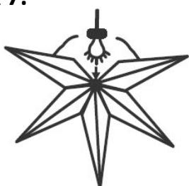
**Vložte žiarovku spolu s chráničom do tienidla a ramená hviezdy uzavorte okolo prívodného kábla. Šnúrku uviažte okolo prívodného kábla, tým budú držať ramená hviezdy zatvorené.**
