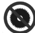
Používání stroje s pilovým kotoučem na dřevo je zakázáno.
