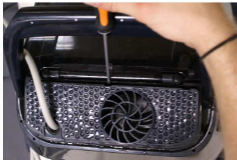
7.1. Pomocou plochého skrutkovača vyberte ochrannú mriežku.
