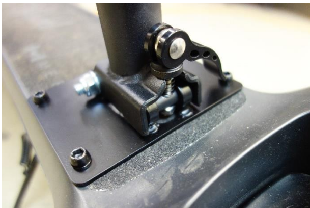
Umístění základny na náslapné ploše elektrokoloběžky a uzamknutý rychloupínací mechanismus.
