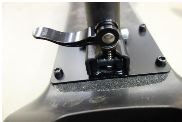
Zaistený rýchlopínací mechanizmus pred dotiahnutím.
