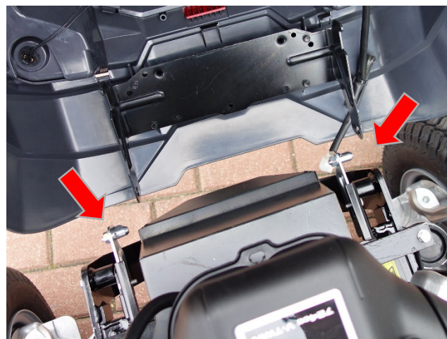
14. Namontujte kapotu zpět, zajistěte jí pomocí závlačky a zapojte napájecí kabel světel.
