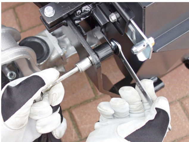
11. Přední horní část rámu sešroubujte s vrchním otvorem v šasi, který původně nesl nárazník traktoru.
