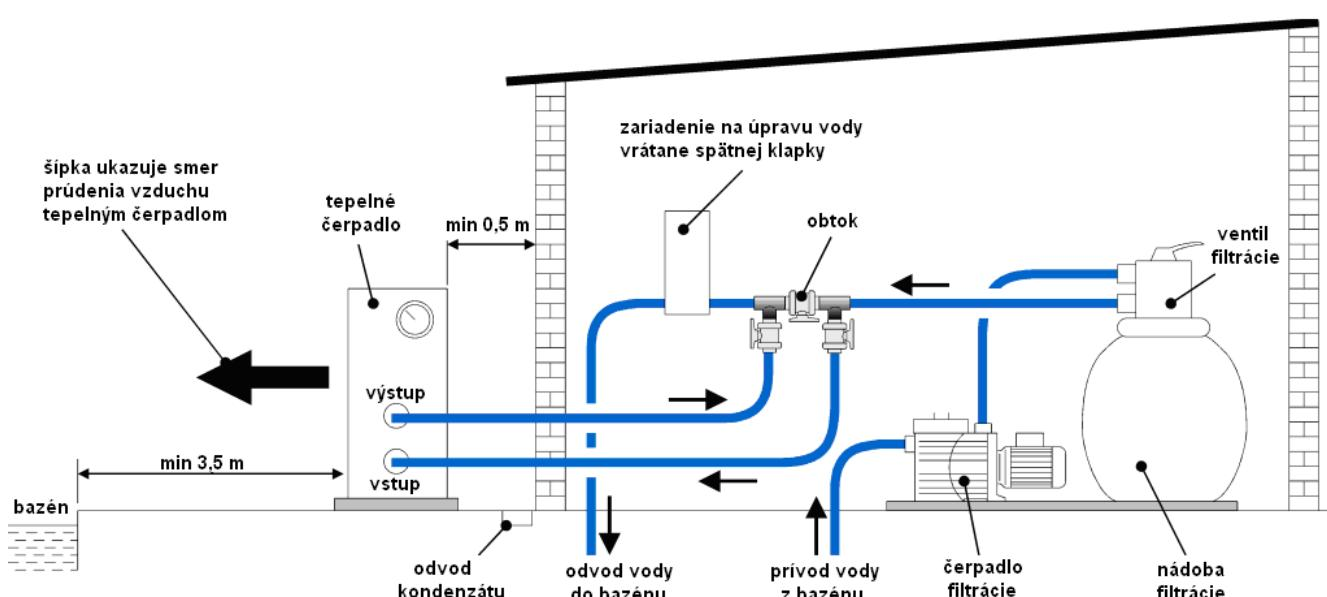
**Poznámka:** Výrobca dodáva iba tepelné čerpadlo. Ostatné súčasti na obrázku sú súčasťami vodovodného okruhu, ktoré zaistuje používateľ alebo inštalačná firma.
