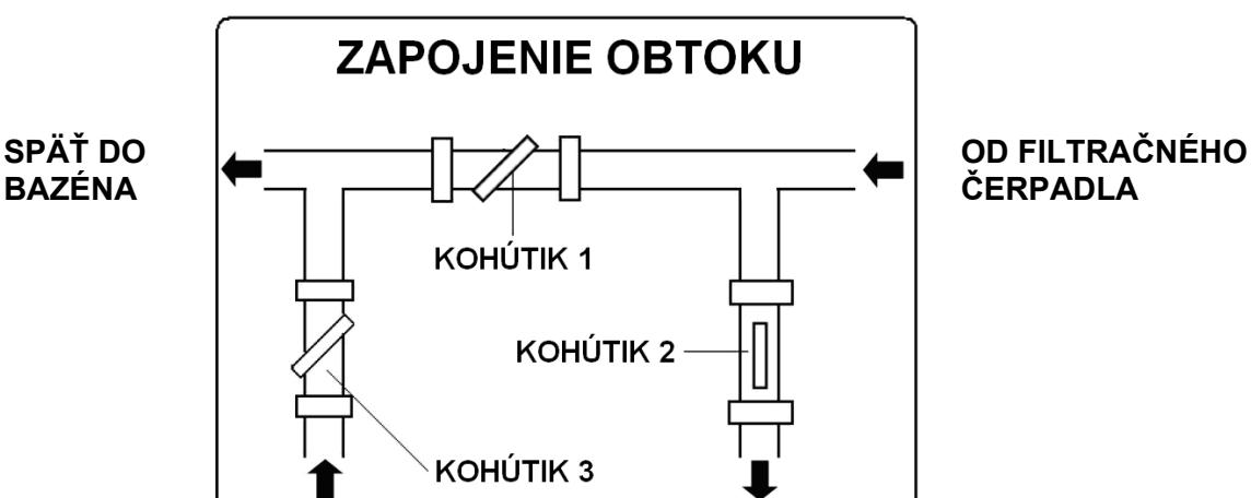
Úplne uzavrite kohútik 1 a otvorte kohútiky 2 a 3 na prívode aj výstupe z tepelného čerpadla. Za týchto podmienok preteká tepelným čerpadlom maximálne množstvo vody. Uvedťte tepelné čerpadlo do chodu v režime ohrevu. Počkajte, až sa hodnota tlaku na tlakomere ustáli. Správne nastavenie tlaku by malo byť v rozmedzí od 21 do 35 kg/cm<sup>2</sup> (bar).
