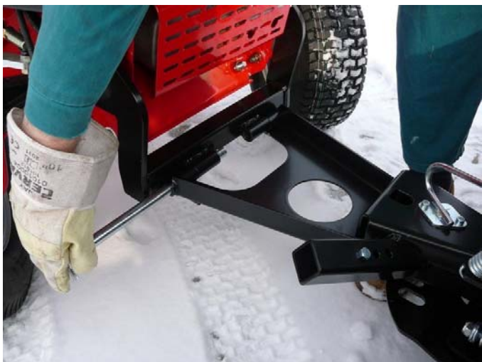
9. Po dotiahnutí rámu nasadíte zmontovanú snehovú radlicu. Zaistíte závlačkou.
