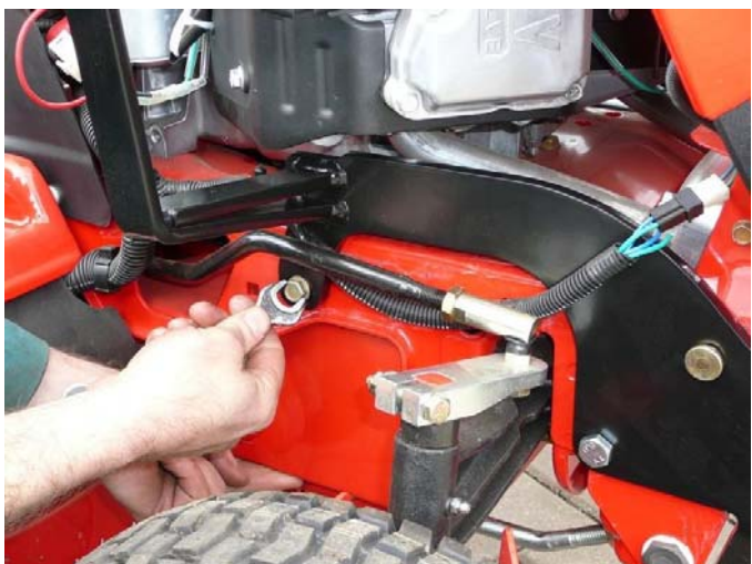
7. Do tretieho otvoru naskrutkujte samoreznú skrutku. Opakujte na druhej strane.
