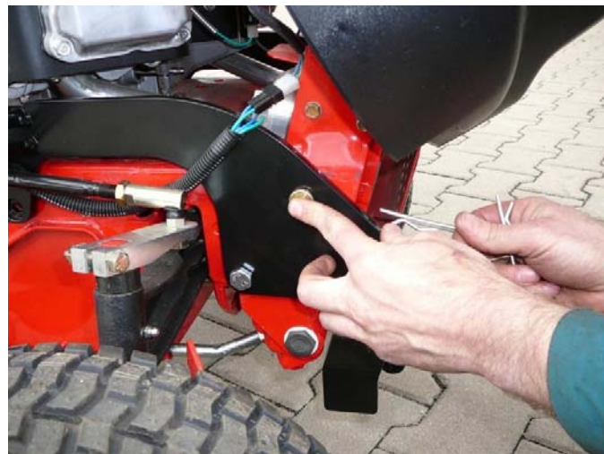
6. Zasuňte späť čap a zaistite závlačkou. Opakujte na druhej strane.
