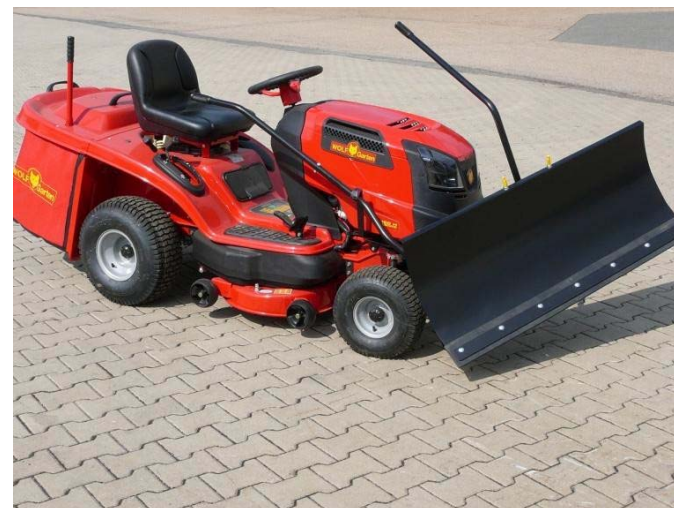
10. Zaistená radlica na ráme traktora, nasadená zdvíhacia a ovládacia páka.
