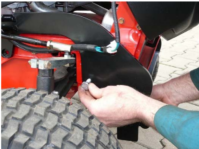
5. Vložte šesťhrannú skrutku a matku a rukou dotiahnite. Opakujte na druhej strane..
