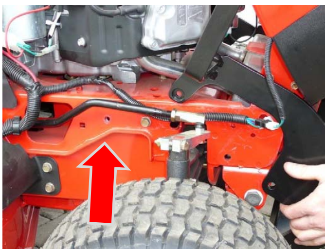
4. Vyskrutkujte samoreznú skrutku po oboch stranách traktora. Podvlečte rám pod elektrickým vedením.
